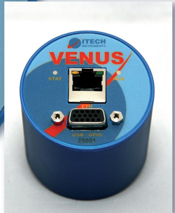
Le **Venus** est un analyseur numérique multicanal compact. Il se connecte aux 14 broches d'un photomultiplicateur équipant les détecteurs à scintillation. C'est un analyseur à forte capacité de comptage sans détérioration de la résolution spectrale. Le **Venus** grâce à sa large gamme de gains et de constantes de mise en forme, est compatible avec tous les modèles actuels de scintillateurs parmi lesquels nous trouvons les NaI, CsI, CeBr3 et LaBr3.
